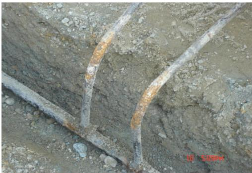
图3 泽园7D和7E腐蚀段开挖结果
