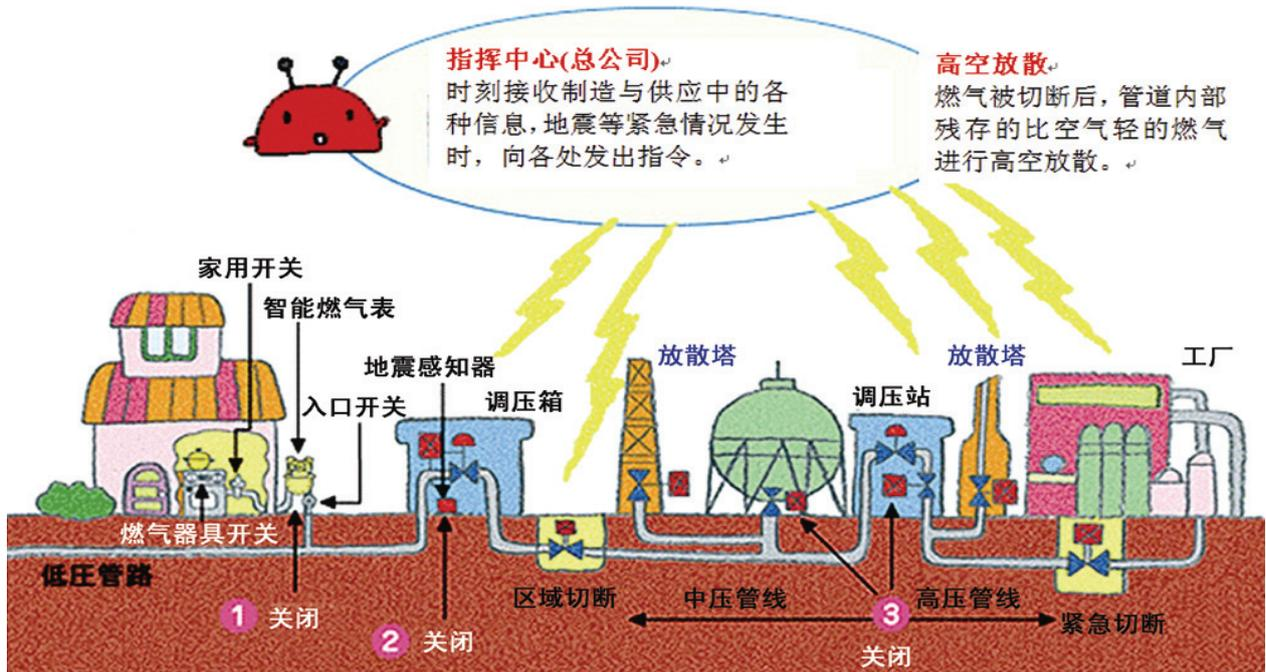
图3 紧急切断示意图
