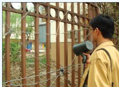
图6 透过栅栏遥测埋地管网
