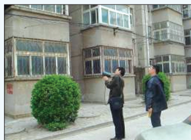
图7 激光探测仪遥测居民户的厨房
