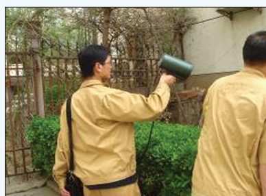
图5 检测花圃内的埋地燃气管道
