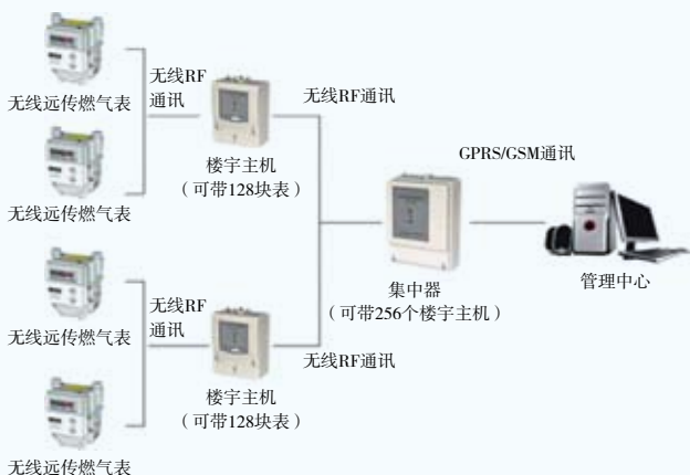
IC卡燃气表无线远程系统结构图
