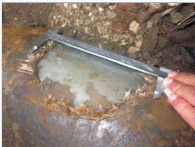
图4 管道防腐层缺陷处现场开挖图
