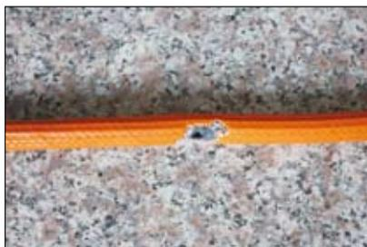
年11月21日~22日，厦门市连续发生3起管道燃气闪爆事故。据厦门华润燃气获悉，这3起事故，经现场勘察发现均为老鼠咬破胶管所致。
