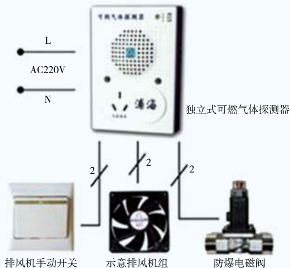
图3 独立式可燃气体报警器
