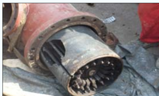
图5 安装后的封堵装置
