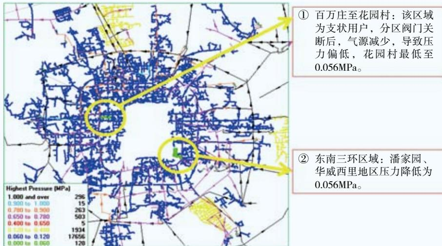
图16 低压管网低压区分布地区 (绿色)
