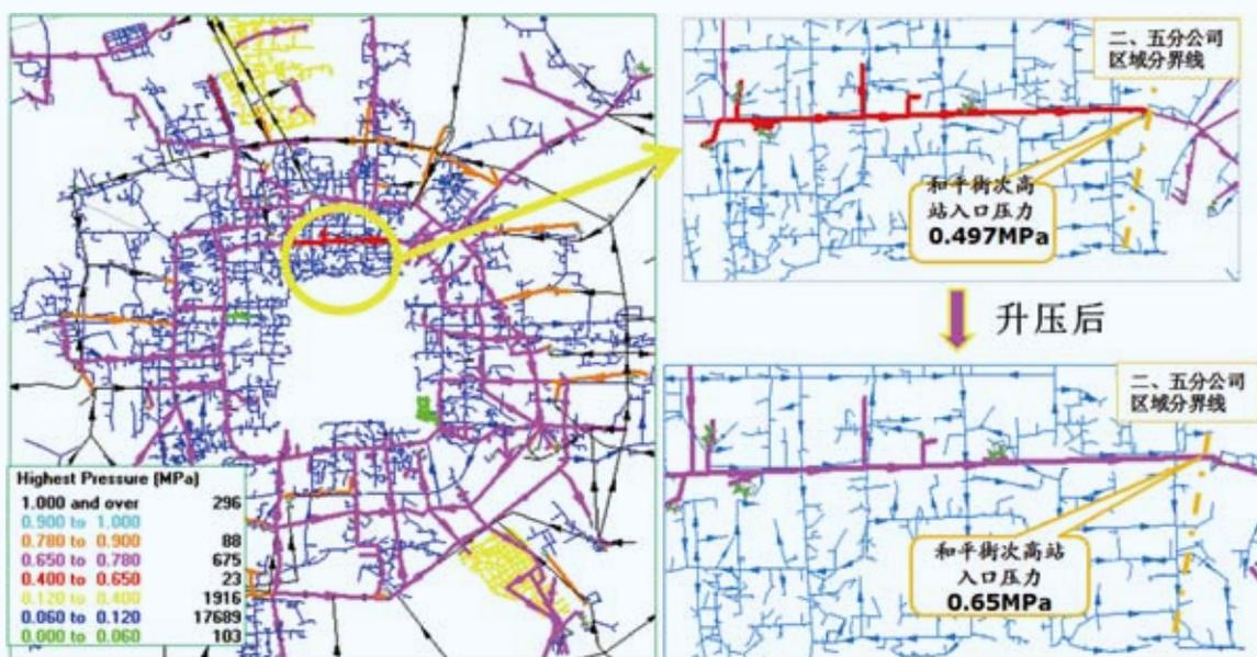
图15 北三环次高压A存在低压区
