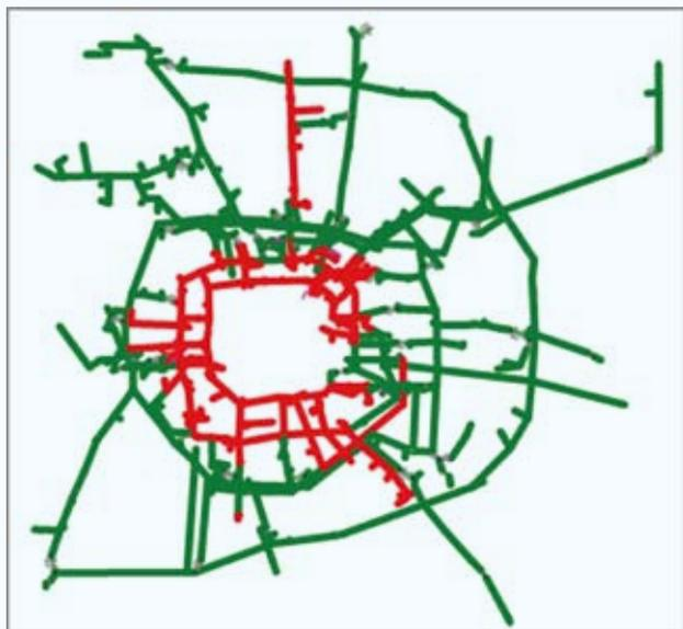
图6（a）管网欠压区域分析
