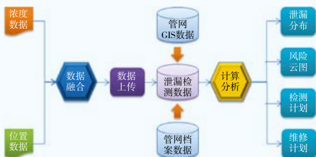
图2 泄漏检测数据集成处理流程
