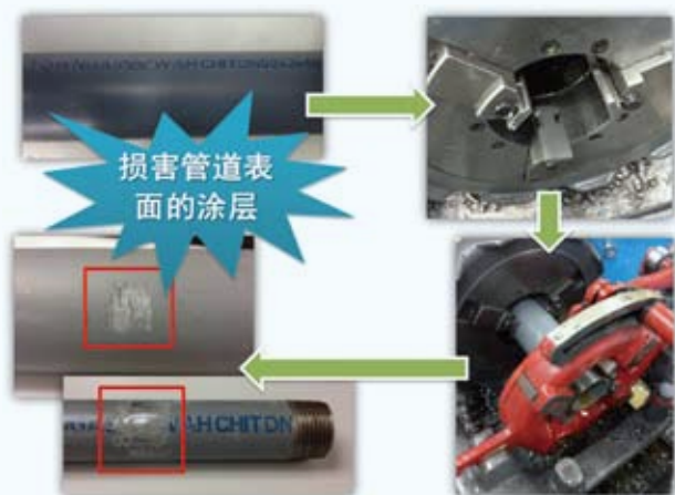
图4 传统套丝方法对防腐层的损伤
