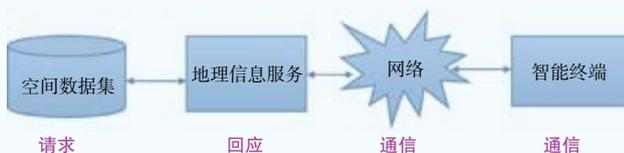
移动GIS主要由空间数据集、地理信息服务、无线网络和移动智能软件终端4部分组成。其中，空间数据集是移动GIS应用的数据基础，它不仅指存储在数据库中的空间数据，而且包括以文件形式存储在服务器上的地图或专题数据。无线网络是连接移动智能终端与地理信息服务的桥梁。地理信息服务是GIS核心应用的后台，借助无线网络，移动端GIS软件访问架设在服务器上的地理信息服务，从而快速、高效地完成相应的GIS功能。移动智能软件终端是一种易于携带、待机时间长、适合野外环境使用、可以用来快速精准定位地理位置的设备。
