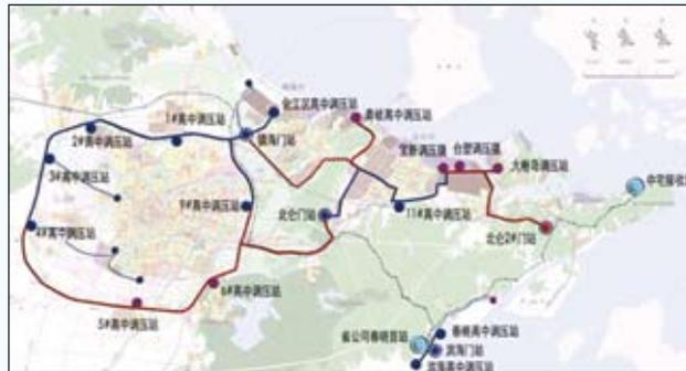
图2 宁波市区已建和规划的高压管网示意
