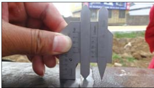
图1 测量焊缝余高图片
