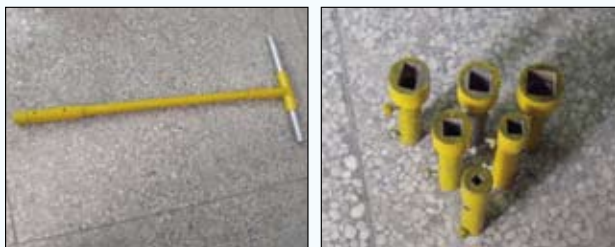
图2 多功能埋地阀门杆及杆头
