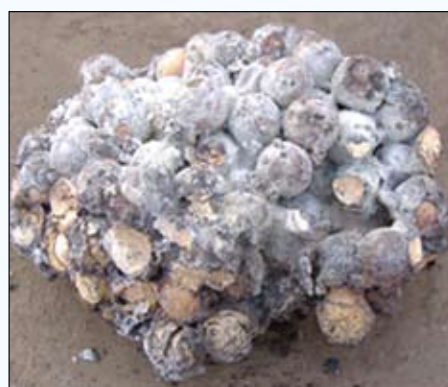
图4 积灰板结的蓄热球
