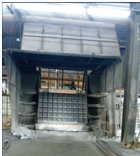
图1 20t的熔铝炉现场图
