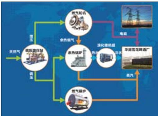
图1 分布式能源项目工作流程图
