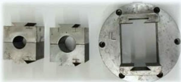
图F.2 拆式夹头
