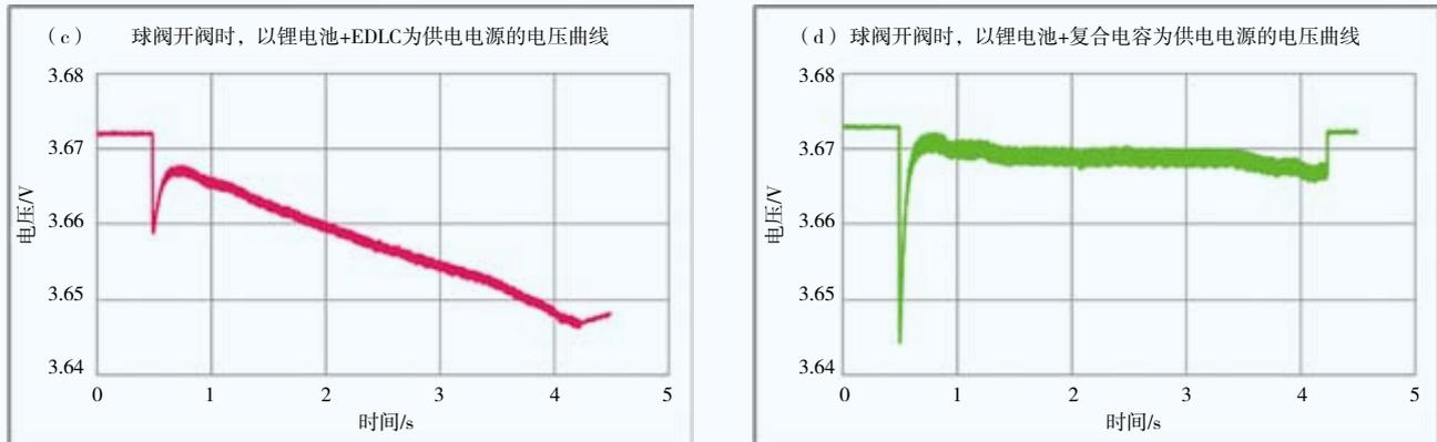
图4 球阀开阀过程中电源电压的变化
