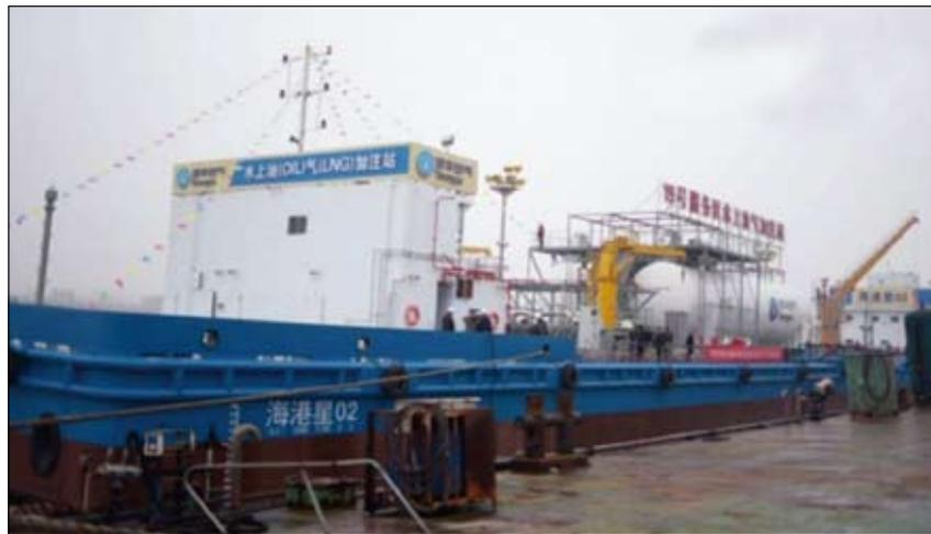
设于长江江苏段19号水上服务区（南京龙潭港），可同时为在长江运营的LNG/柴油燃料动力船舶提供加注服务。该船型长136m，配备有2个250m<sup>3</sup>的LNG（液化天然气）储罐，柴油仓可储油约2 000余t，是目前已投资建设完成的全国单体最大、功能最全的水上油水气综合
