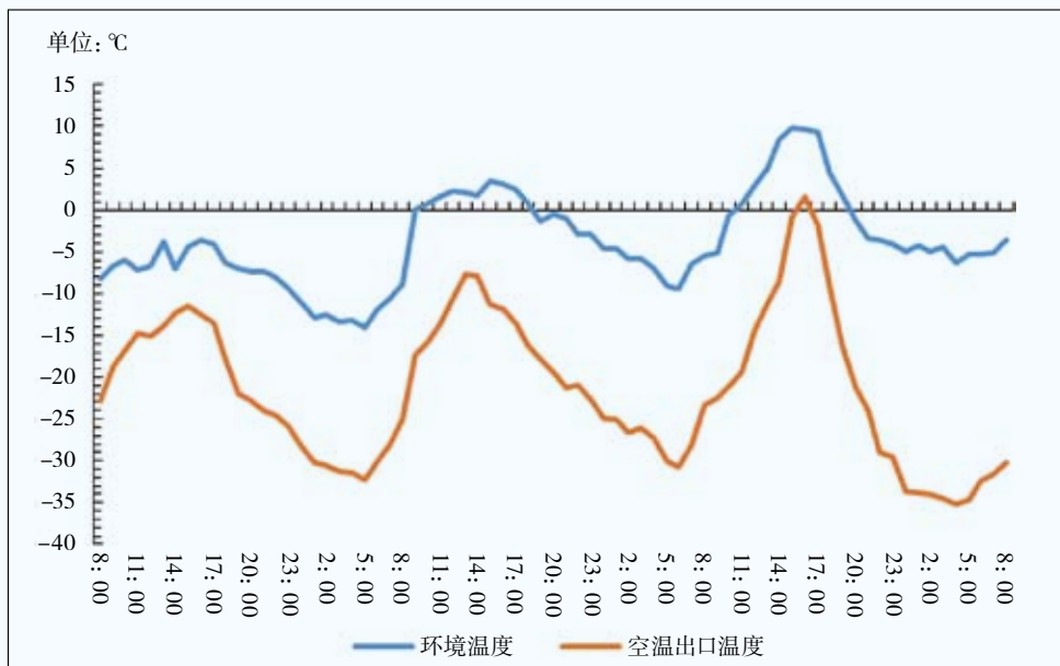
图3 环境温度和空温出口天然气温度关系图
