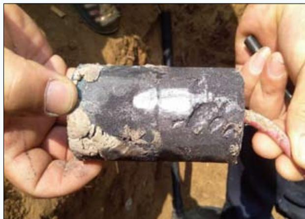
图3 长效参比电极内部图
