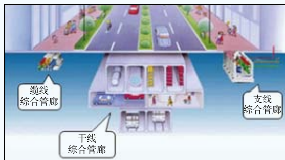
图1 综合管廊地下示意图
