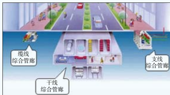
图1 综合管廊地下示意图
