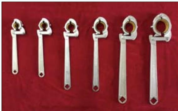
图16 6种型号管钳成品
