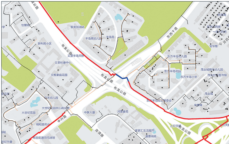
图1 因管道改造形成主干管道断点图示
