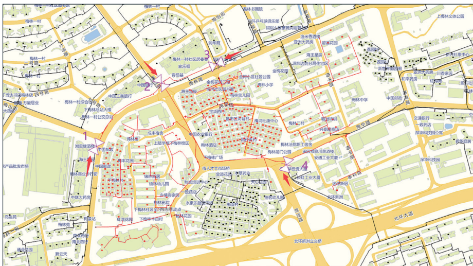
图2 某片区中压管网阀门分析图示
