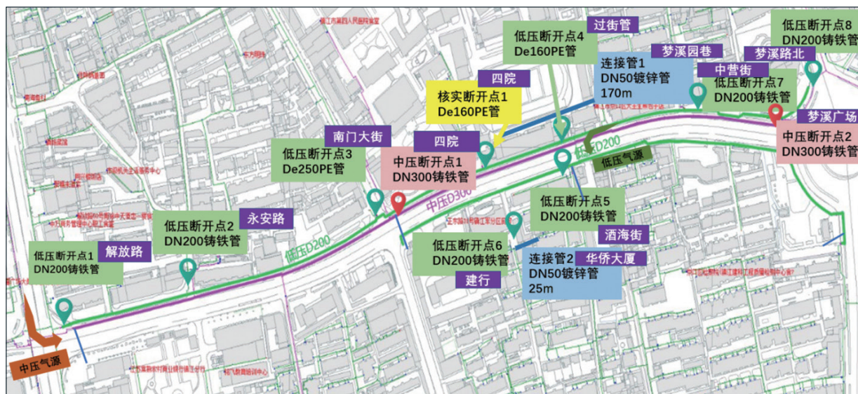
图2 正东路改造设计方案示意图
