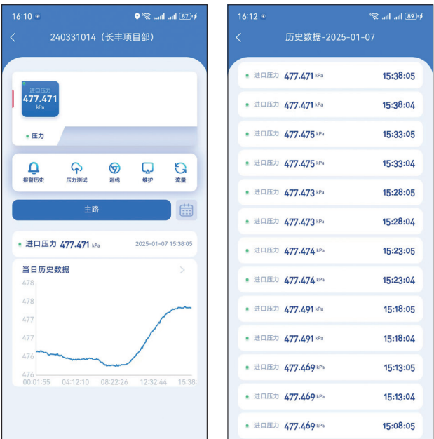
图3 Smart Gas系统移动端线上实时展示压力试验监测数据
