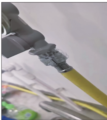
图3 灶具连接管处定性模拟燃气微小泄漏
