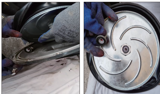
图1 某燃气公司调压设施突然损坏导致中压燃气直接窜入低压燃气管道
