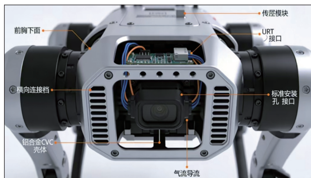
图2 检测模块与机器狗本体结构集成设计示意图
