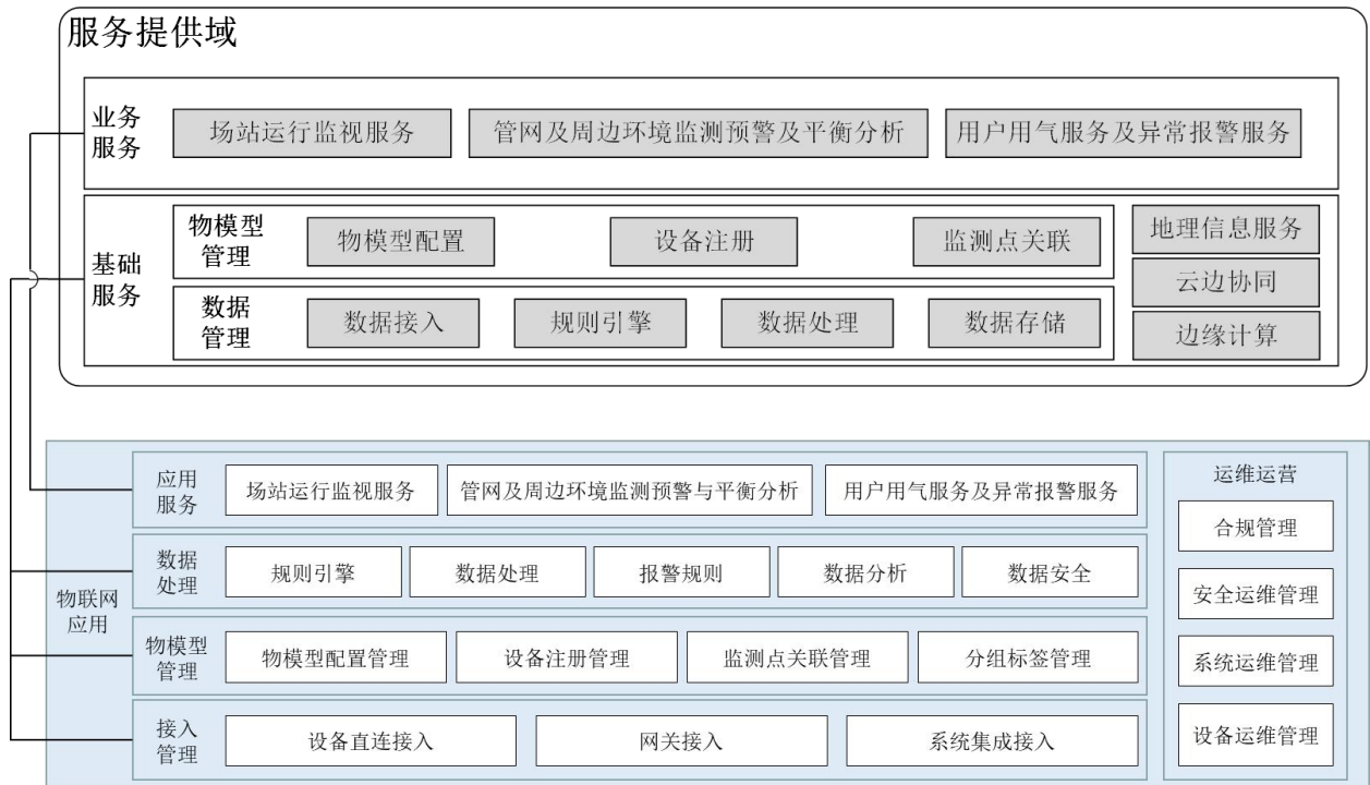
图 6 物联网应用层与服务提供域的映射关系
